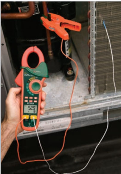
Zwei Typ-K-Eingänge zur Ermittlung der Temperaturdifferenz bei Überhitzungsmessungen.
