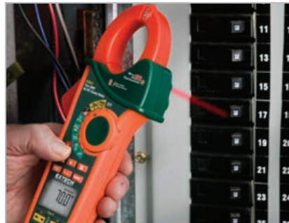
Das integrierte IR-Thermometer eignet sich zur raschen und sicheren berührungslosen Temperaturmessung.
