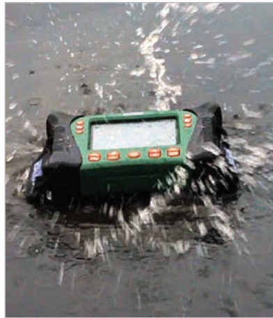
Stoßfestes und wasserdichtes Gehäuse nach IP67.
