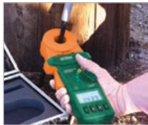
Widerstandsprüfung von Erdungsnetzen bei Mobilfunk- und Kommunikationsmasten
