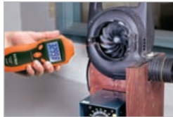
Mesure de la vitesse (tr/min) des objets en rotation et compte-tours (rotation) des objets en mouvement.
