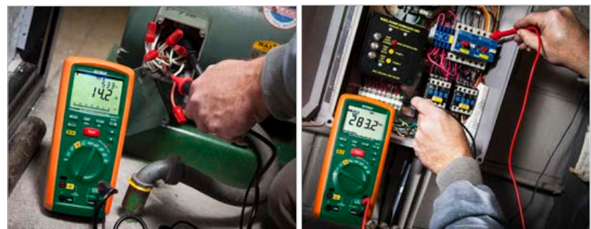
Vérification de la tension sur un tour et test d'isolement sur un moteur de pompe.
