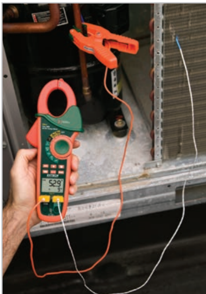
Double entrée type K pour mesures différentielles de température en cas de surchauffe.
