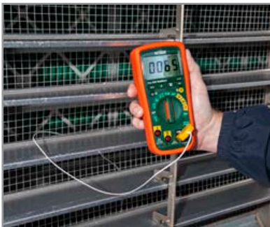
Controllo temperatura in uscita sui sistemi di climatizzazione con il modello EX355
