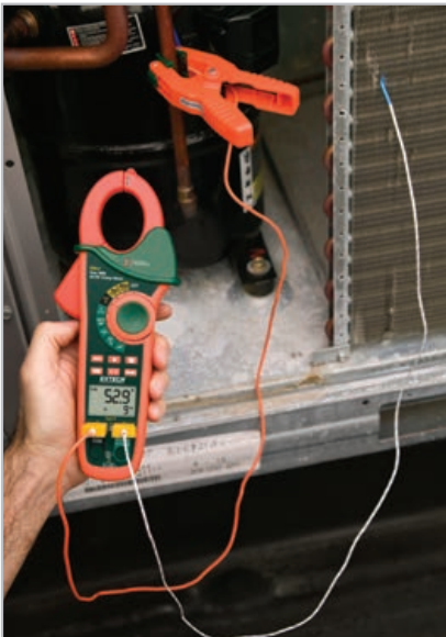
Doppio ingresso tipo K per letture di temperatura differenziale necessarie per misurare un surriscaldamento.
