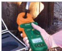
Controllo resistenza delle reti di messa a terra di tralicci per telefonia cellulare e comunicazioni radio.
