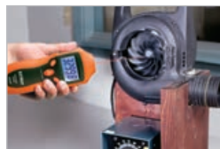
Misura la velocità (RPM) di oggetti rotanti e conteggi (rivoluzioni) degli oggetti in movimento.
