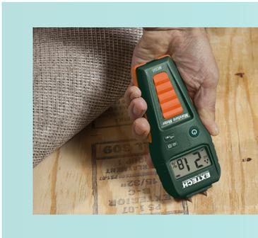
使用这款便利的紧凑型湿度计，快速在木材和建筑材料上测得湿度参考值。显示屏上的图标表示湿度水平，易于操作，另外还有声音警报功能。在建筑修缮工程和应用中，检测地板上以及地毯下的水分非常重要，这款仪器是在这些应用中测定湿度的理想工具。如需分析墙壁后面和天花板漏水所产生的不良影响，这款仪器是您的必备工具。
